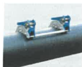
c) Montare dispozitiv top-load
